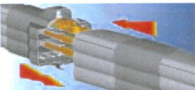
Durch die neuartige Verbindungstechnik geht die Montage der Stemmann-Conductor Line SCL im Handumdrehen vonstatten. Lediglich aus Schienenverbindern und Stoßabdeckung bestehend, ist die Verbindungstechnik komplett vorkonfektioniert. Bei der eigentlichen Montage ist es lediglich notwendig, pro Leiter eine Mutter anzuziehen und die Abdeckhälften einzurasten.
